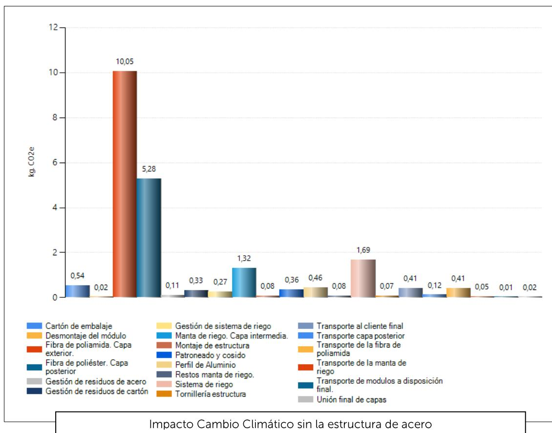
Se puede observar cómo, eliminando el acero, destacan las fibras de poliamida y de poliéster como principales elementos con afección al cambio, seguidos del sistema de riego y la manta de riego, todos ellos elementos de origen plástico.
